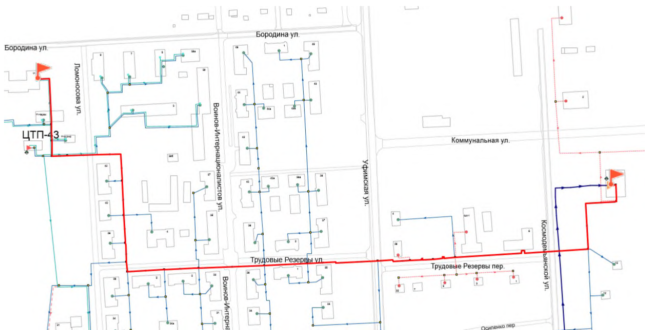
Рисунок 2.23 - Путь теплоносителя по направлению от «ЦТП 42» до потребителя «ул. Бородина,11»
