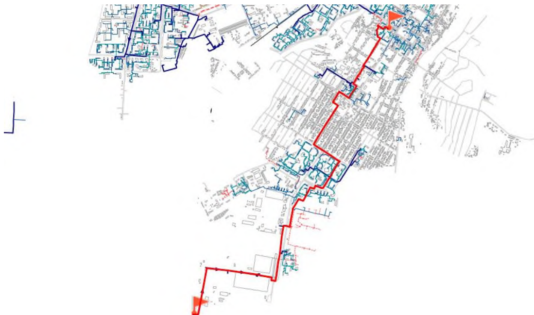
Рисунок 3.1 - Путь теплоносителя по направлению от котельного цеха №7 до обобщенного потребителя «ЦТП 20»
