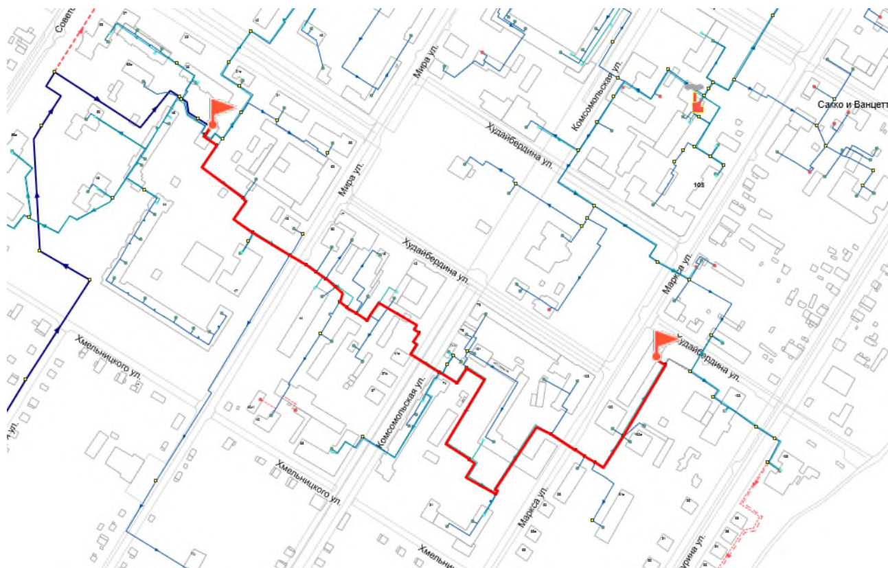
Рисунок 3.3 - Путь теплоносителя по направлению от «ЦТП 20» до потребителя «ул. К. Маркса,102»
