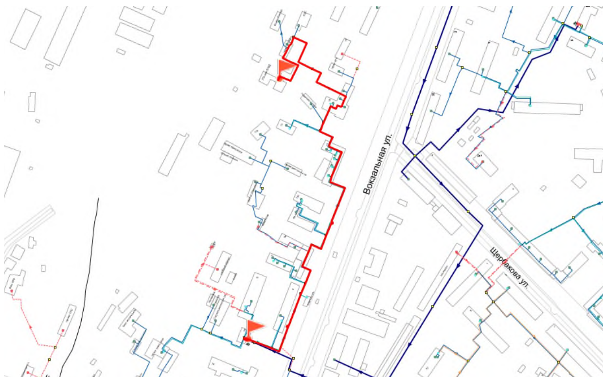
Рисунок 2.7 - Путь теплоносителя по направлению от «ЦТП 31» до потребителя «ул.Вокзальная,21д»
