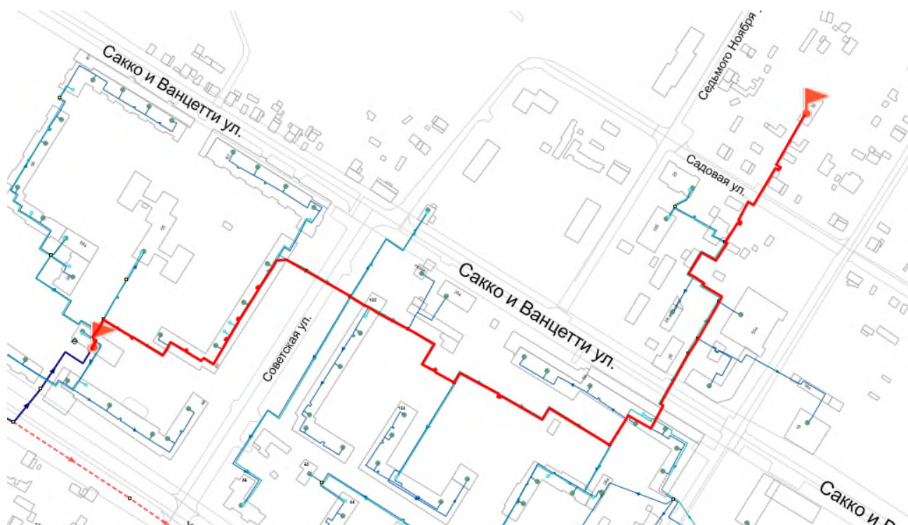
Рисунок 2.15 - Путь теплоносителя по направлению от «ЦТП 19» до потребителя «ул. Садовая,32»
